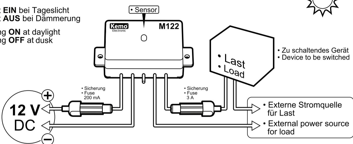
**D | Achtung!** Wie aus den Zeichnungen ersichtlich, kommt aus dem Ausgang des Moduls keine Spannung zum direkten Anschluss einer Lampe. Im Modul ist ein Relaiskontakt enthalten, der die Lampe schaltet. Sie müssen also die Betriebsspannung für die Lampe extra zuführen (gemäß Zeichnung). Es kann die gleiche Spannungsquelle sein, mit der auch das Modul betrieben wird! Oder auch eine andere Spannungsquelle, falls die Lampe eine andere Betriebsspannung hat als 12 V.
