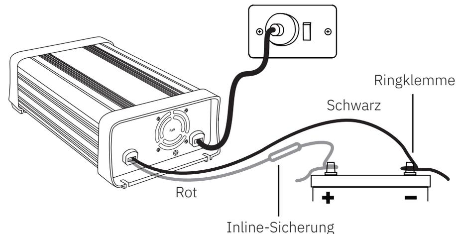
Wenn Sie das Ladegerät dauerhaft bzw. fest verbunden nutzen und das Fahrzeug über einen längeren Zeitraum nicht nutzen, empfehlen wir Ihnen das Ladegerät mit dem Stromnetz verbunden zu lassen. So kann die Batterie vollgeladen erhalten werden.
